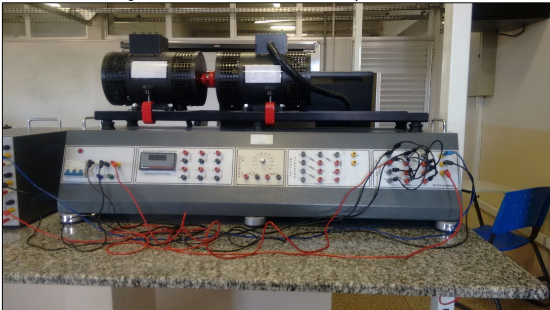
Figura 5.1 – Bancada de acionamento de máquinas elétricas.
