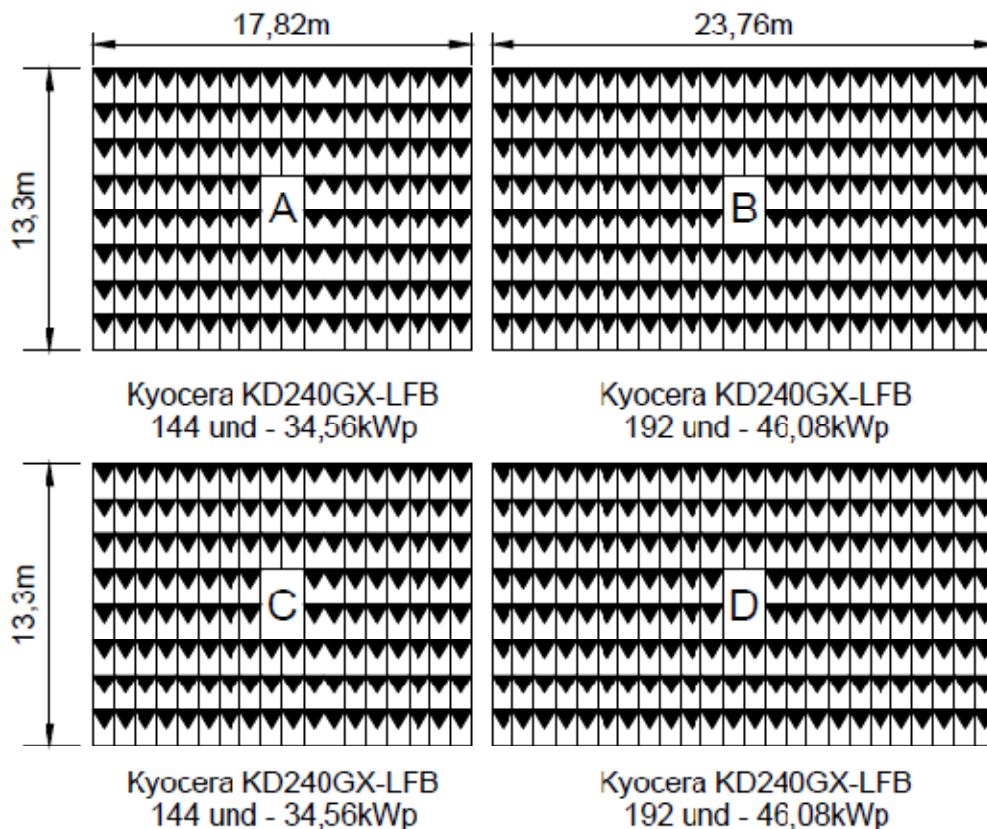
Figura 19 - Posicionamento dos módulos e medidas da instalação no estacionamento.
